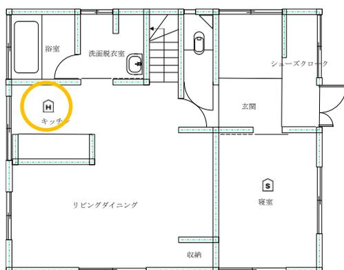
キッチンに煙式を設置していることがありますが、調理中に誤作動の恐れがあるため、**熱感知器の設置**を推奨しています。熱感知器の凡例は『H』の記号です。
